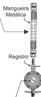
Regulador de Pressão conforme NBR 8473
