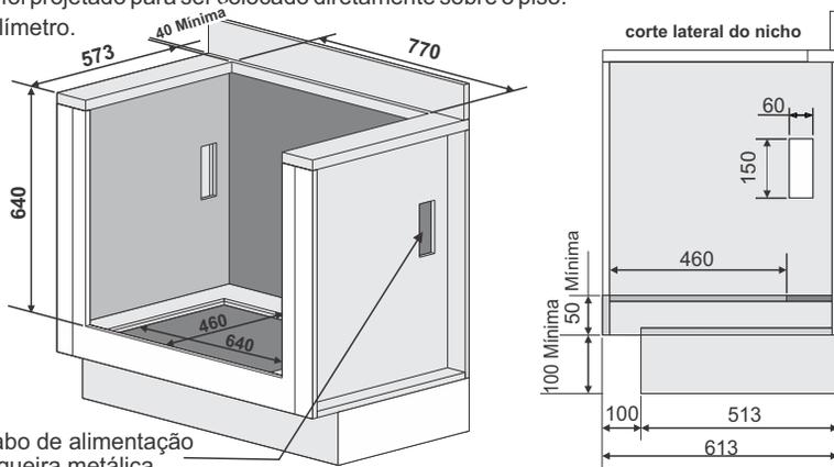
Saída para cabo de alimentação e da mangueira metálica
