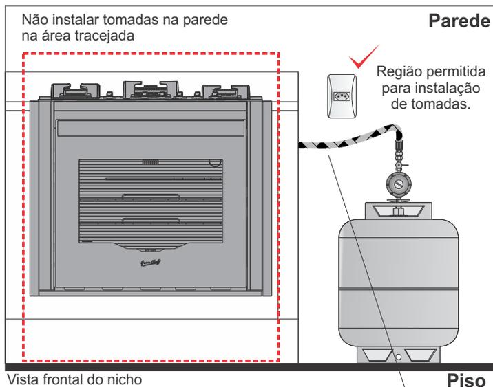
**NOTA:** Nunca instale um fogão de embutir com uma mangueira plástica PVC ou mangueira plástica revestida de metal, pois a temperatura do forno pode danificar o componente e provocar vazamentos com risco de explosão.
